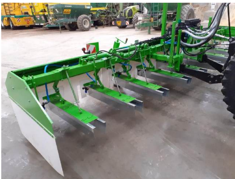
Exemple d'un pulvérisateur sous capot de protection. © Deruyttere.
