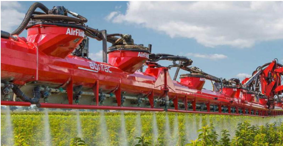
Voorbeeld van een spuittoestel uitgerust met luchtondersteuning. © Agrifac.
