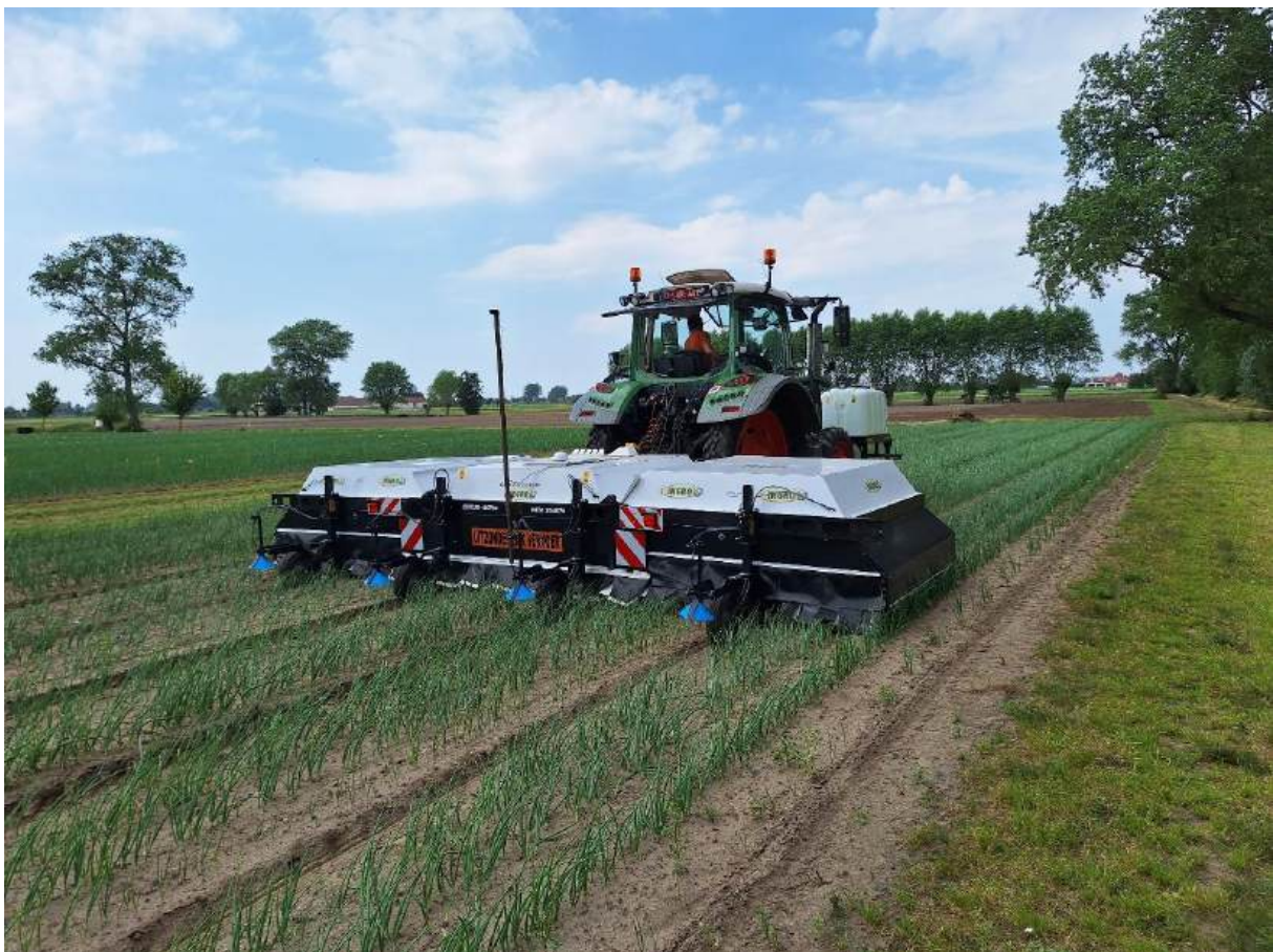
Voorbeeld van een spuit onder overkapping.
