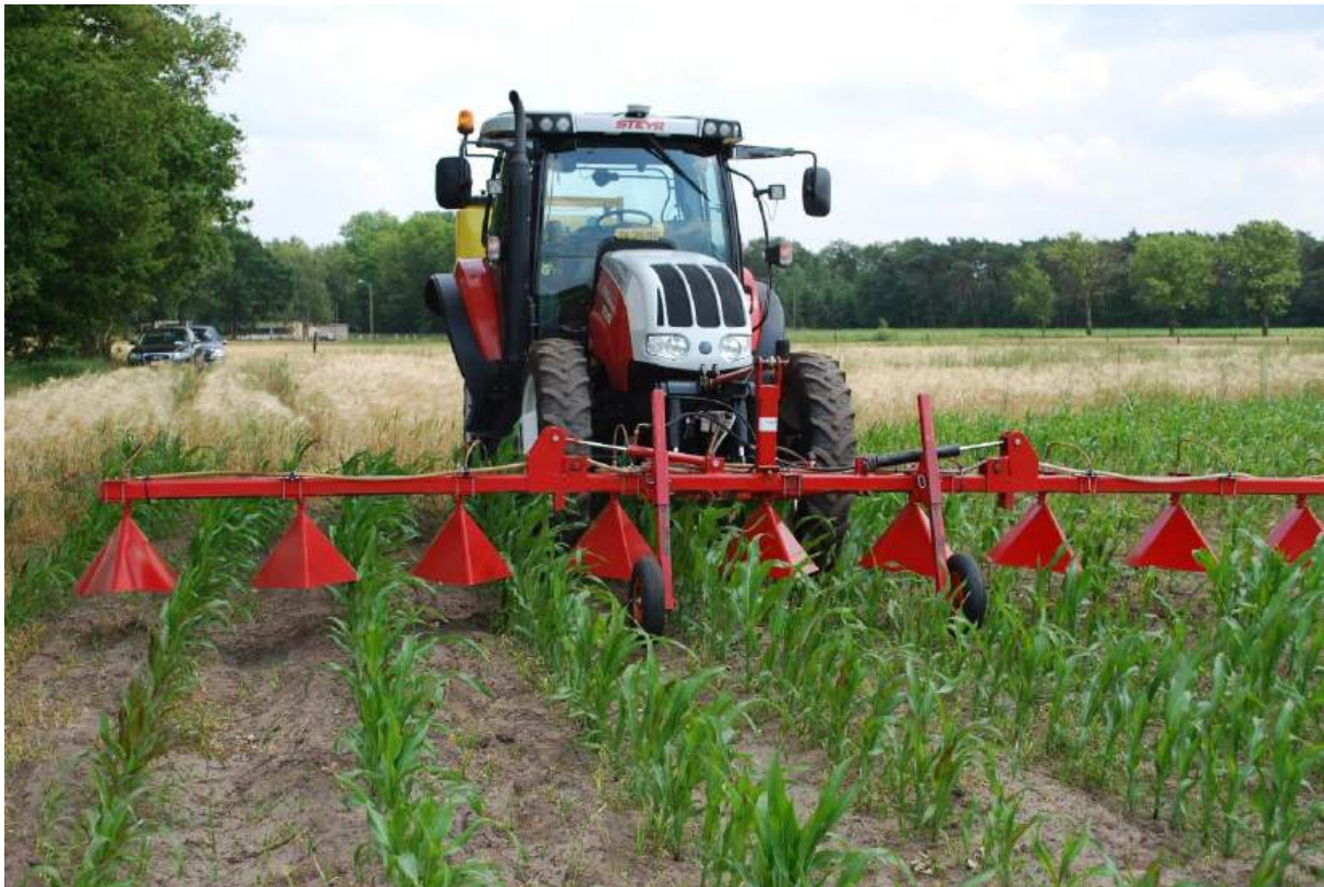
Voorbeeld van een spuit onder overkapping.
