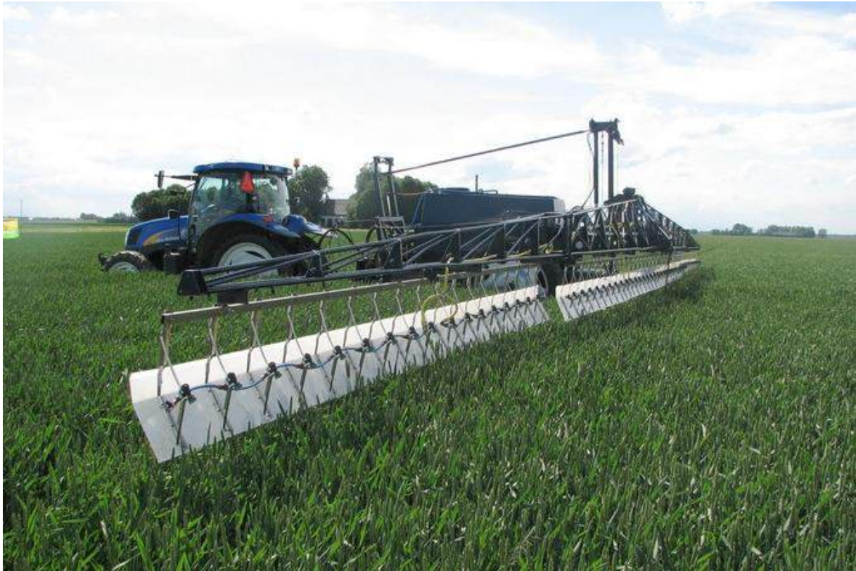
Voorbeeld van een spuittoestel uitgerust met sleepdoek.
